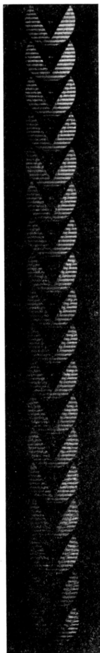
Abb. 8. N_2 - H_2 -Strömung um einen 60^\circ -Keil, A'/A = 144 ; M_s = 4 ; \Delta t = 2 \cdot 10^{-4} s.
