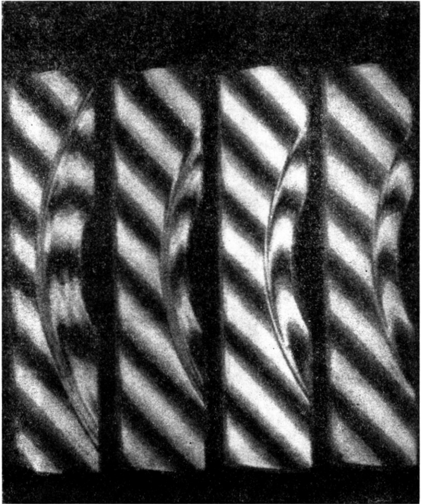
ABB. 10. \text{CO}_2\text{-H}_2 — Strömung um einen Zylinder, A'/A = 11,6 ; M_S = 7,1 ; \Delta t = 4 \cdot 10^{-8} \text{ s} .
